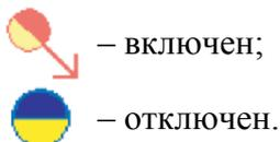
Условное обозначение водоразборной колонки в зависимости от режима работы:
