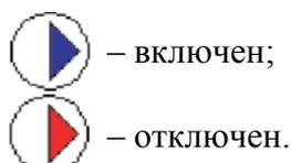
Условное обозначение водонапорной башни в зависимости от режима работы:
